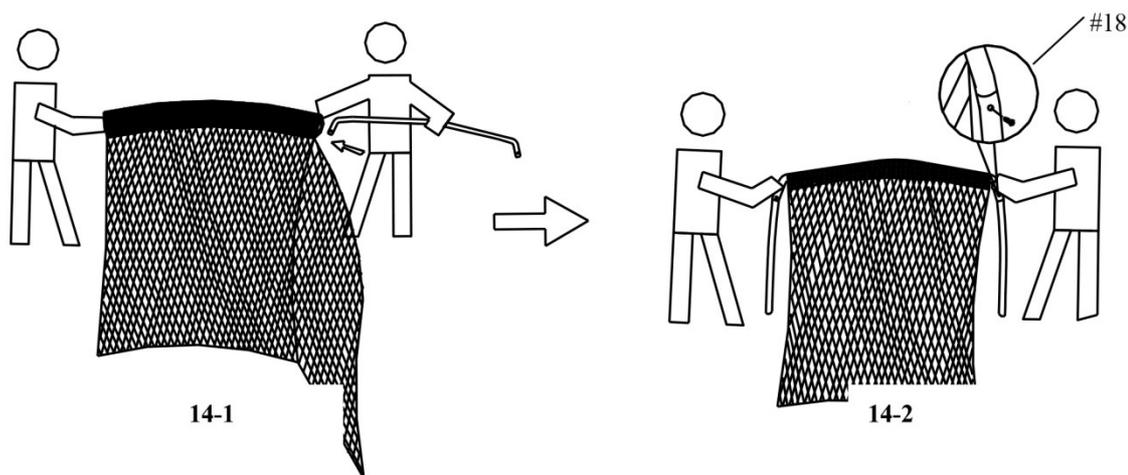
4.1 Проденьте горизонтальную трубу (#13) в верхнюю часть защитной сети и соедините с обеих сторон с деталью (#18) Защитная сеть должна находиться с внешней стороны. Аккуратно расправьте защитную сеть и закрепите с помощью эластичного ремешка в нижней части сети.
