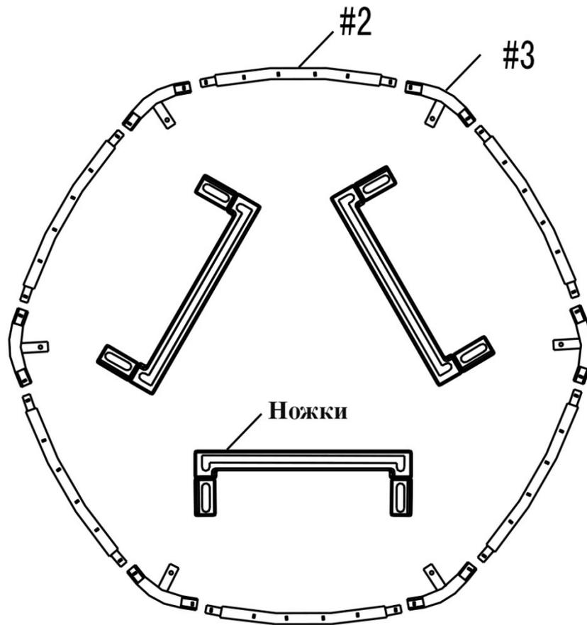
2.1 Начните сборку основной конструкции батута с того, что поместите деталь (#3) в разъем в вертикальной части ножек.
