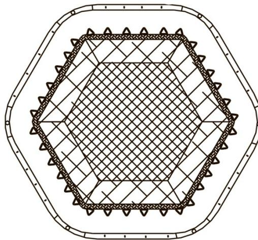
Для удобства сборки поднимите защитный мат. Необходимо 2-ое взрослых для данного этапа сборки батута. При установке пружин будьте аккуратны, во избежание защемления пружиной. Для установки пружин пользуйтесь ключом изображённым ниже.
