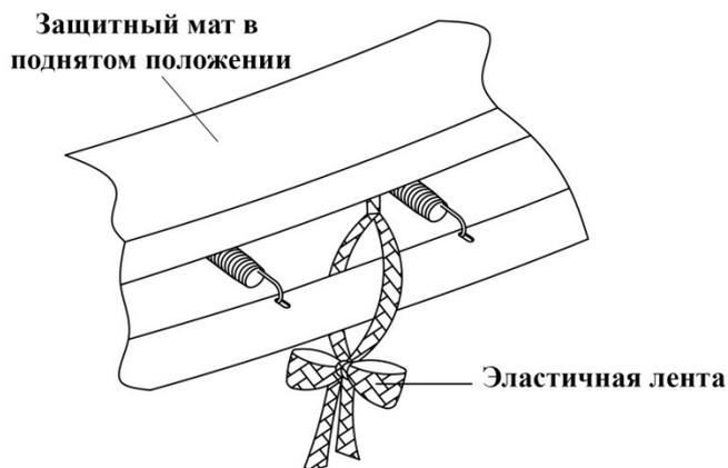
После завершения установки пружин, закрепите мат к раме, чтобы надёжно скрыть пружины. Для этого воспользуйтесь лентами по периметру мата батуа. Хорошо закрепите мат к основной раме. Прежде чем продолжить сборку, проверьте качество всех креплений и правильность их установки. Закрепите карточку с инструкцией по безопасности.
