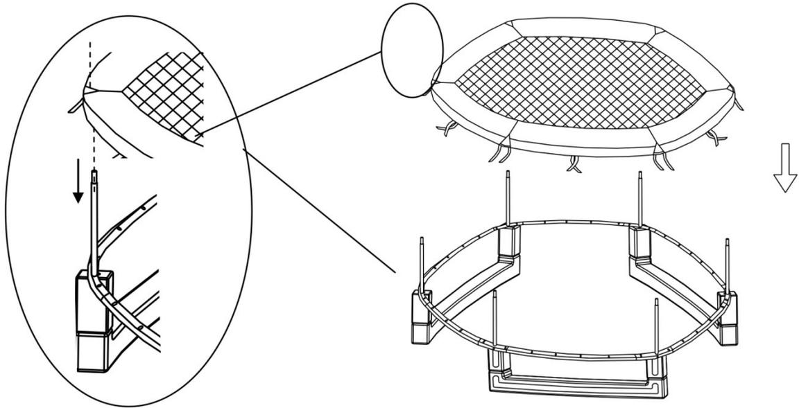
3.2 У данной модели есть 36 колец для крепления пружин к полотну и столько же отверстий в основании батута. Далее описан порядок установки пружин.
